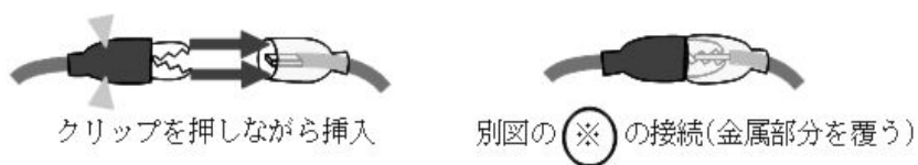
図 発信器のコードの先端にミノムシクリップを差し込む
